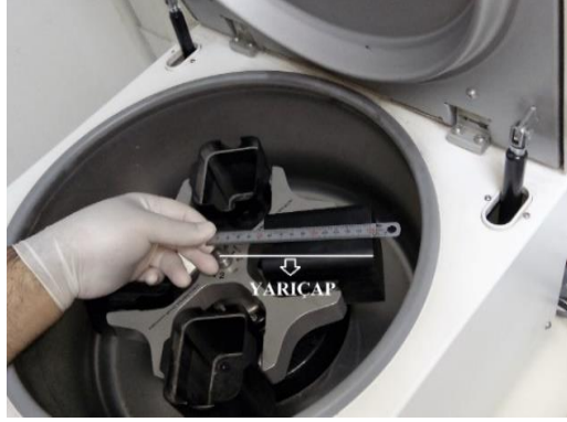
Şekil 9. Santrifüj yarıçapının ölçülmesi
